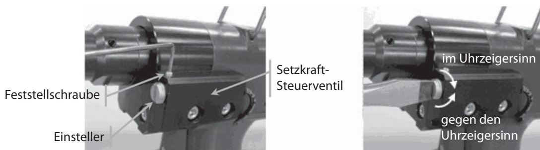
Abbildung 14: Einstellen der Setzkraft
