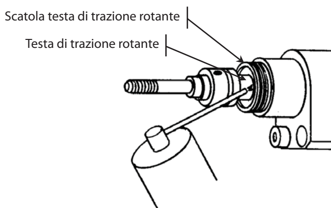
Figura 16. Lubrificazione della testa di trazione rotante
