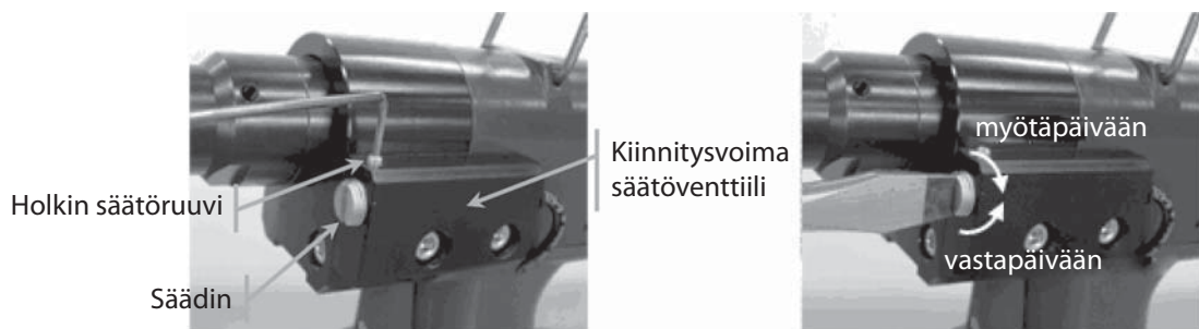
Kuva 14: Kiinnitysvoiman säätäminen
