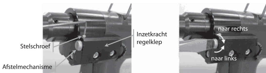
Afbeelding 14: Aanpassing van de inzetkracht
