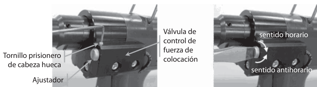
Figura 14: Ajuste de la fuerza de colocación
