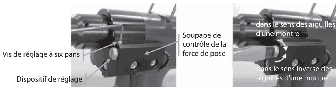
Figure 14 : Régler la force de pose
