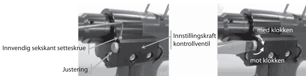
Figur 14: Justering av innsettingskraft
