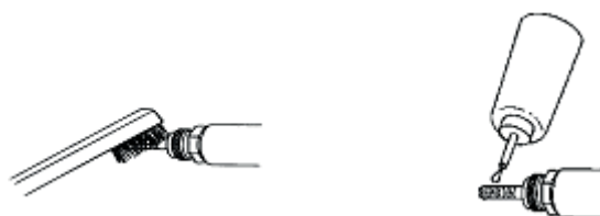
Figura 15. Pulizia e lubrificazione del tirante
