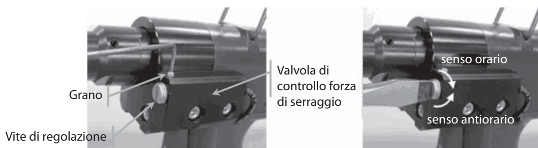
Figura 14. Regolazione della forza di serraggio
