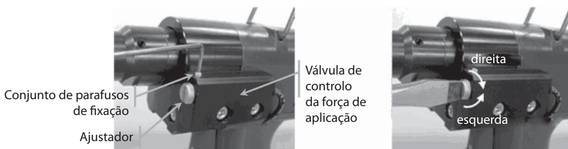
Figura 14: Regular a força de aplicação
