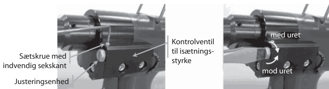
Figur 14: Justering af isætningsstyrke
