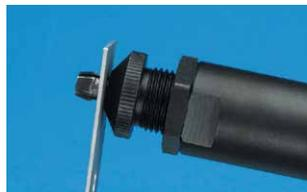
Insérer le poinçon dans le trou cylindrique et déclencher le cycle du 74290.
