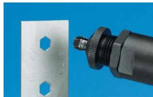
Le trou hexagonal est formé par le 74290 et peut recevoir un écrou à sertir type Hexsert®.
