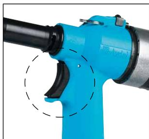
Gâchette de commande unique, une impulsion permettant le déroulement du cycle complet – sertissage et dévissage
