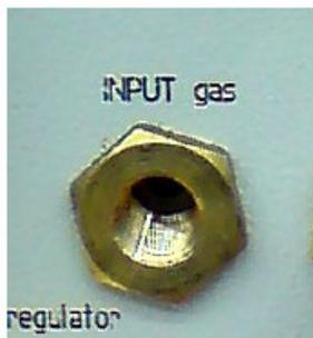
お客様からのシールド・ガス用ホースをこのプラグに接続します。シールド・ガスはガスレギュレータ、圧力計及びマルチカップリングのソケットを介して、エアホースにて溶接ツールに供給されます。
