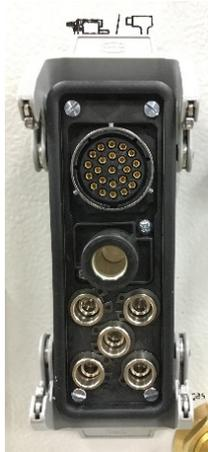
このコネクタには、溶接ヘッドまたは溶接ガンのケーブル・パッケージのマルチカップリング・コネクタを接続してください。
