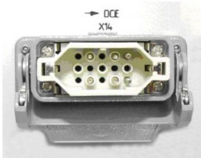
このコネクタには、DCE MAXコントロール・ユニットとのコントロール・ケーブルを接続してください。このコントロール・ケーブルは、本装置の入力電源線とDCE MAXコントロール・ユニットと本装置間の通信線から構成されています。
