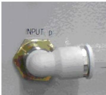
圧縮空気入力部からの圧縮空気は、このINPUT-pソケットに接続されています。
