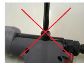
フィルスクリュの緩め・締め付けは、大型ドライバで行ってください。ドライバ先端部の幅・厚さが不十分ですと フィルスクリュの締付不足(オイル洩れ)・破損につながります。
