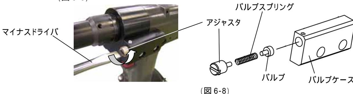
適合するバルブスプリング(表 2-2 P.4 参照)へ交換し、バルブ及びスプリングを組み付け、アジャスタを約 3 回転締め込みます。
