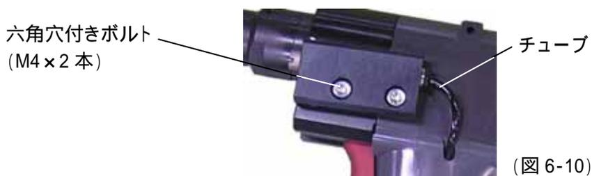
荷重設定バルブを交換し、六角穴付きボルト(M4×2本)を締めて固定します。
