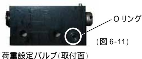
荷重設定バルブの継手にチューブを繋ぎます。
