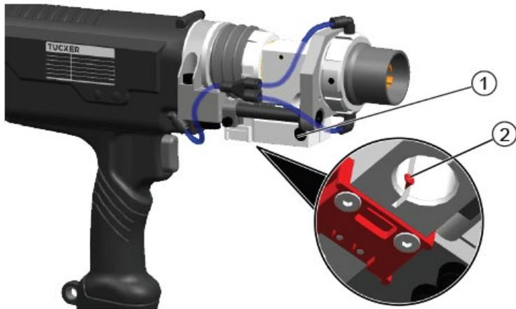
⇒ フィードチューブの一端をカップリングプレートのストッパーまでスライドさせます。
