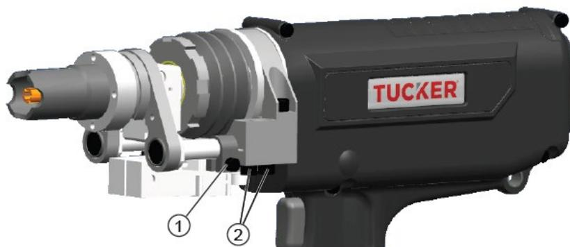
⇒ フラッシュシールドの先端が上を向くように溶接ガンを配置してください。
