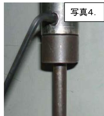
プッシュロッドはインデックススプリング先端の引掛け部に取付けます。
